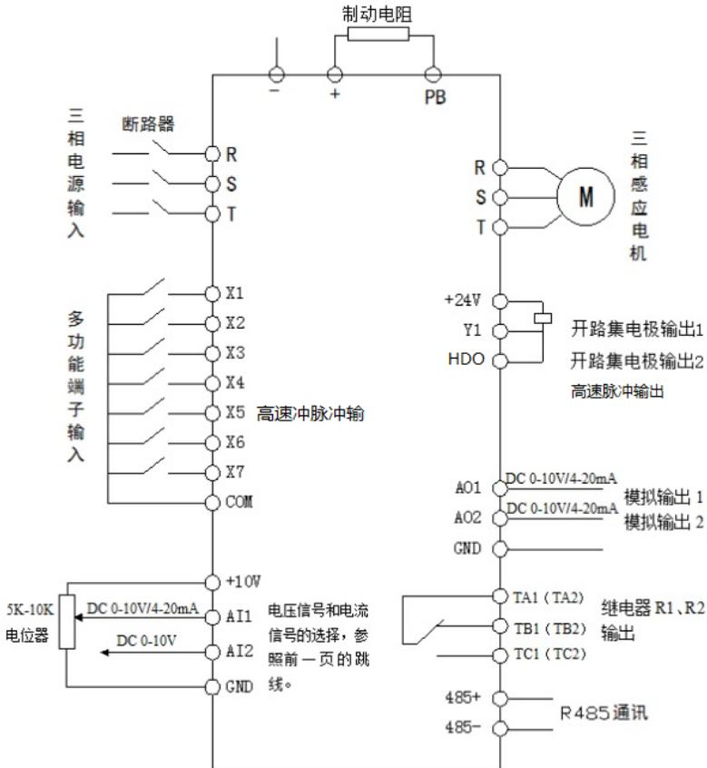
图 2-2 变频器控制回路接线方式
