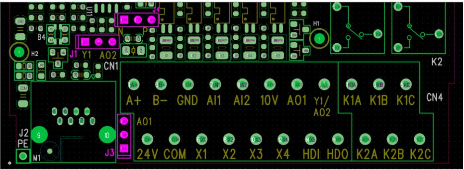
图 2-4 AC730（隔离版本）控制回路端子布置图
