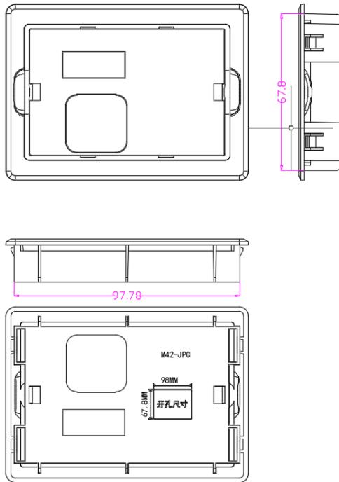
图 1-4 外引键盘的外型尺寸
