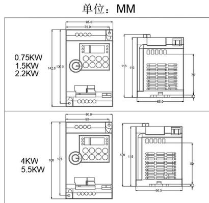
图 1-1 AC360 变频器结构外型尺寸及安装尺寸示意图
