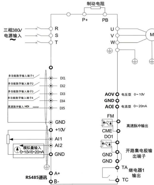
图 2-2 变频器控制回路接线方式
